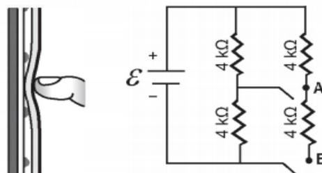
Qual é a resistência equivalente no circuito provocada por um toque que fecha o circuito no ponto A?
