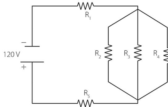
Sabe-se que  $R_1 = 3 \Omega$ ,  $R_2 = R_3 = R_4 = 6 \Omega$  e  $R_5 = 1 \Omega$ .
